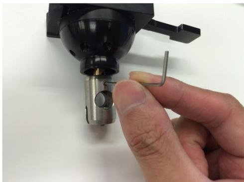
試料クランプを本体へ取り付けてレバーを差し込んで状態を確認してください。
