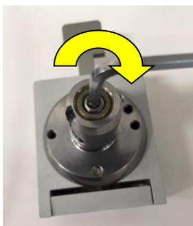
試料クランプを裏返し、円柱の軸を押さえながら、真ん中の穴に 3mm の六角レンチを差し込み、90° 程度ずつ回して微調整します。
