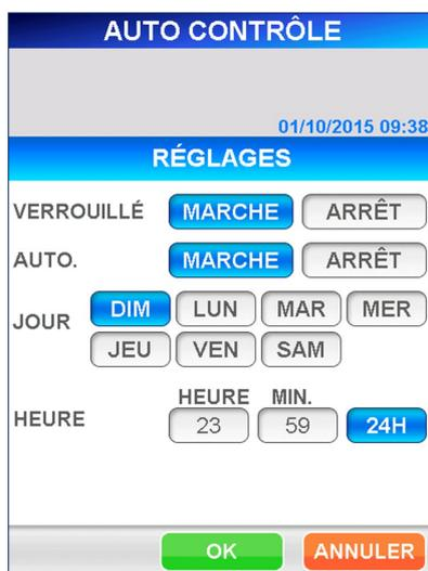
Il est possible de sélectionner [MARCHE] ou [ARRÊT] pour la fonction [VERROUILLAGE] (réglage par défaut : ARRÊT). Lorsque [VERROUILLAGE] est réglé sur [MARCHE] et qu'un problème apparaît une fois l'auto-contrôle terminé, la touche de démarrage barrée s'affiche et aucun dosage n'est autorisé par la suite (mode verrouillage). Dans ce cas, relancez l'auto-contrôle.
