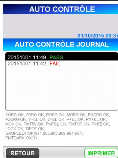
Sur l'écran ci-dessus, les résultats des auto-contrôles réalisés antérieurement peuvent être revus et imprimés. En sélectionnant une substance à l'écran, des informations détaillées sur le journal sélectionné s'affichent dans la partie inférieure de l'écran.
