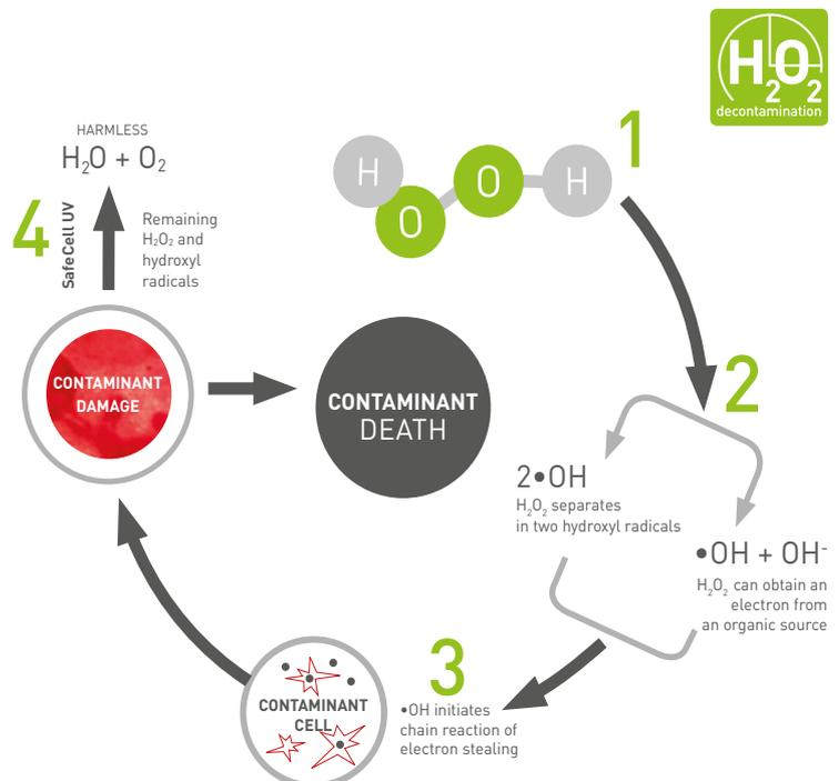
La descontaminación de H<sub>2</sub>O<sub>2</sub> de PHCbi alcanza como mínimo 6 unidades de reducción logarítmica de los principales contaminantes. El proceso de descontaminación total lleva menos de tres horas.
