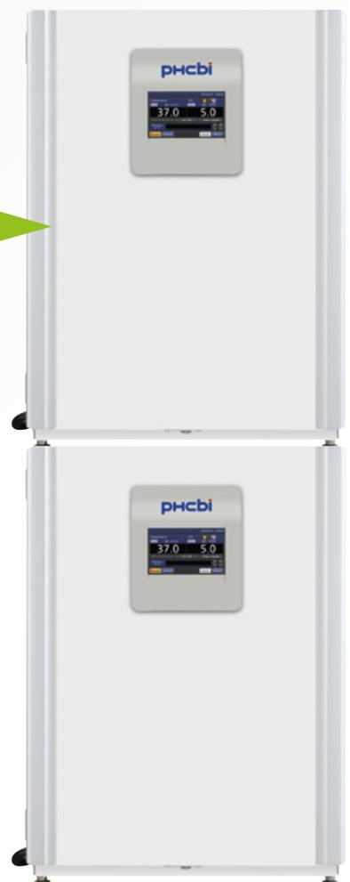
Para evitar quemaduras durante el ciclo de esterilización con calor, la puerta exterior se bloquea electrónicamente. La temperatura de la superficie superior del MCO-170AICD durante la esterilización por calor es de aproximadamente 60 °C. 60 °C está dentro de la tolerancia descrita en la norma internacional de seguridad IEC 61010 10.1: Límites de temperatura de la superficie para la protección contra las quemaduras. El límite de seguridad para el metal externo es de 65 °C.
