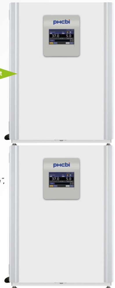
Um Verbrennungen während des Heißluftsterilisationszyklus zu vermeiden, wird die Außentür elektronisch verriegelt. Die Oberflächentemperatur der Oberseite des MCO-170AICD während der Heißluftsterilisation beträgt etwa 60 °C. Dieser Wert von 60 °C liegt innerhalb der Toleranz, die in der internationalen Sicherheitsnorm IEC610101.1, Grenzwerte für Oberflächentemperaturen zur Vermeidung von Verbrennungen, beschrieben ist. Der Sicherheitsgrenzwert für Außenverkleidungen aus Metall beträgt 65 °C.
